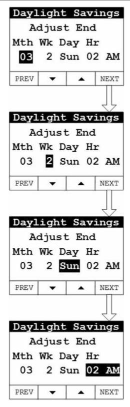
FIGURE 6. DAYLIGHT SAVINGS TIME (END TIME SETUP)
