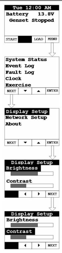
FIGURE 8. BRIGHTNESS AND CONTRAST SCREEN
