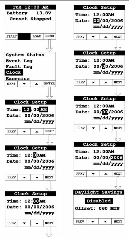
FIGURE 2. CLOCK SETUP SCREEN
